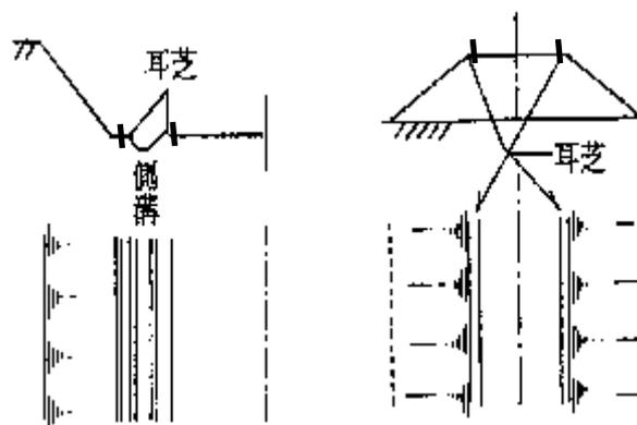
7. 受注者は、張芝の施工に先立ち、施工箇所を不陸整正し、芝を張り、土羽板等を用いて地盤に密着させなければならない。次に湿気のある目土を表面に均一に散布し、土羽板等で打ち固めなければならない。
