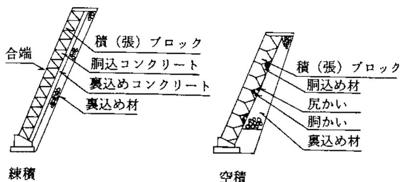
図3-3 コンクリートブロック工
