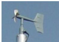
風向（風の向き）、風速（風の速度）を測定します。
