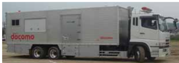
【大型移動電源車】
