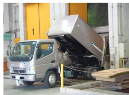
■可燃ごみピットへのごみの投入
